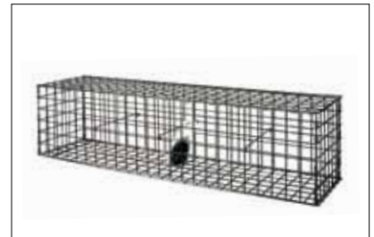
Schanskorven | Gabionen | Gabions 4,5 mm Draaddiameter | Drahtdurchmesser | Diamètre de fil | Wire diameter 50x50 mm Maas | Masche | Maille | Mesh 120x30x30 cm
