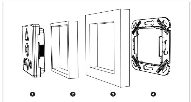
Abb. 2 Montageaufbau für den WMS Wandsender
