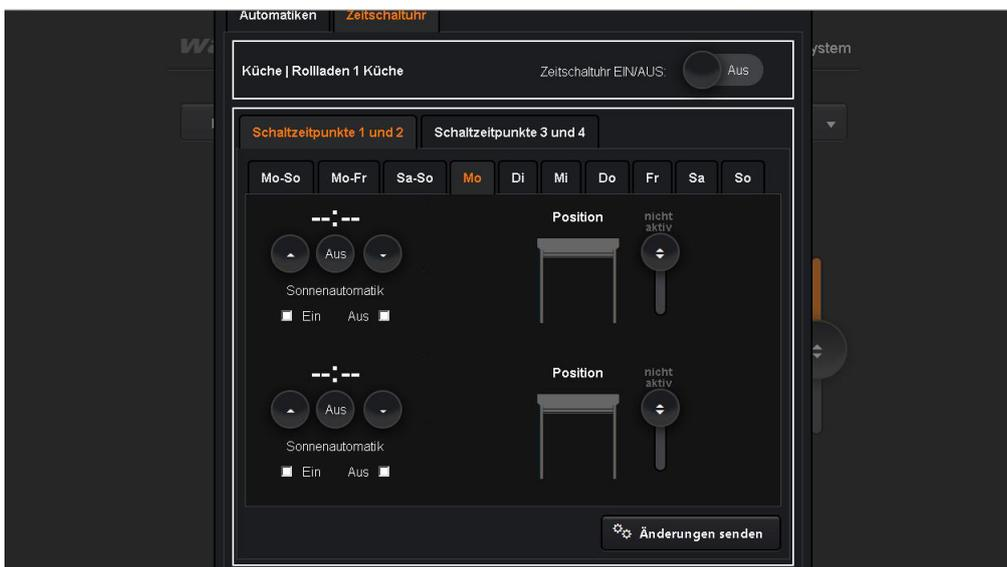
Abb. 18 Die Zeitschaltuhr mit den verschiedenen Eingabemöglichkeiten für Schaltzeitpunkte und die Aktivierung der Sonnenautomatik.
