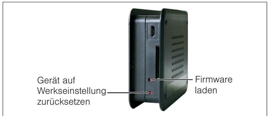
Abb. 26 Taster zum Laden der Firmware
