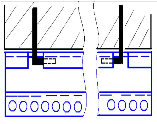
Profil aufgehängt an zwei, gegen oben verschraubte Winkelschrauben
