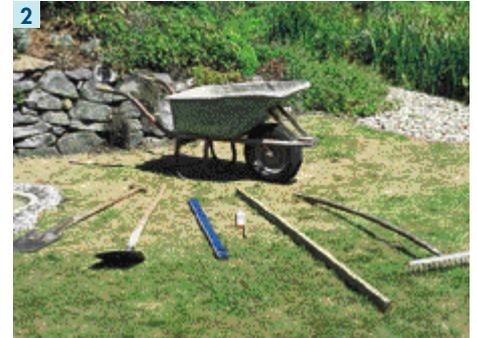
Legen Sie sich folgende Werkzeuge bereit: Spaten, Schaufel, Füllsand, Wasserwaage, Zollstock und einen Gartenschlauch mit Wasseranschluss.
