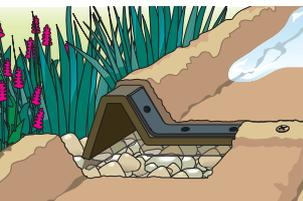
OASE-Bachlaufschalen lassen sich sehr natürlich in die Umgebung einpassen. Die in Handarbeit hergestellten Einzelmodule bestehen aus glasfaserverstärktem Kunststoff, die Oberfläche aus natürlichem Material. Jedes Modul ist ein Unikat, eine Einzelanfertigung, denn der Sandsteincharakter wird durch das Auftragen von echtem südafrikanischen Sand erreicht.
