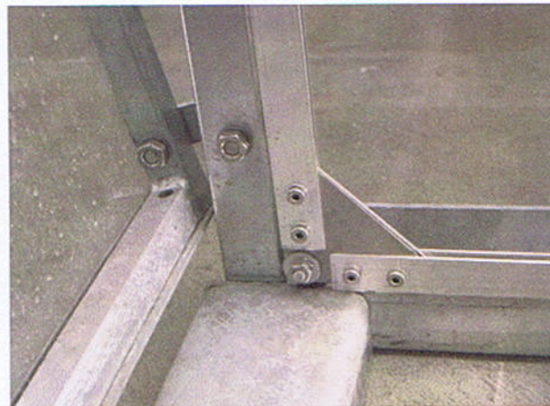
Kleine Verbindungsplatte (aussen) an Fuss anschrauben (6-kant M8 x 20mm)
