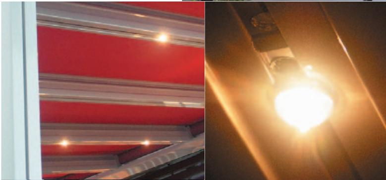
Das optional erhältliche Lichtsystem sorgt für stimmungsvolles Ambiente. Die Halogenlampenschiene ist in den Längsbalken integriert. Je nach Ausladung der Anlage und gewünschter Ausleuchtung stehen 2-flammige (40W), 3-flammige (60W), oder 4-flammige (80W) Lampenschiene zur Auswahl. Das Lampensystem lässt sich dimmen\*. Der Abstand der Leuchtmittel beträgt 75 cm.
