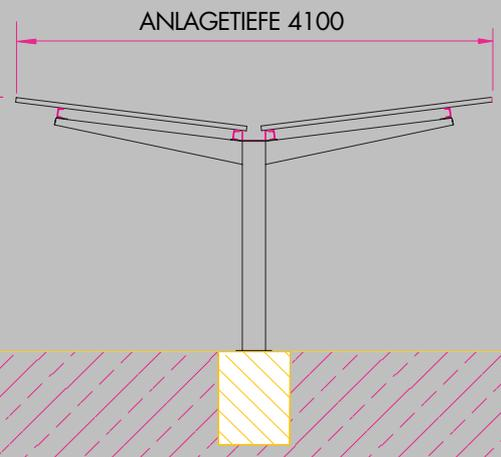
ANLAGEBREITE = ANZAHL MODULE X 3700 + 500MM
