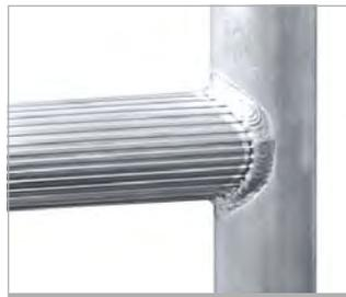
Rundum verschweißte Sprossen-Holm-Verbindung
