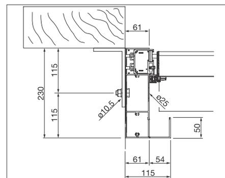
Schnitt Trägerprofil (Deckenmontage)
