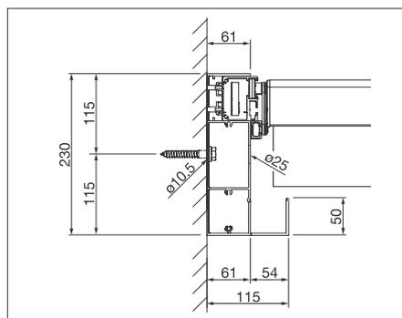
Schnitt Trägerprofil (Wandmontage)
