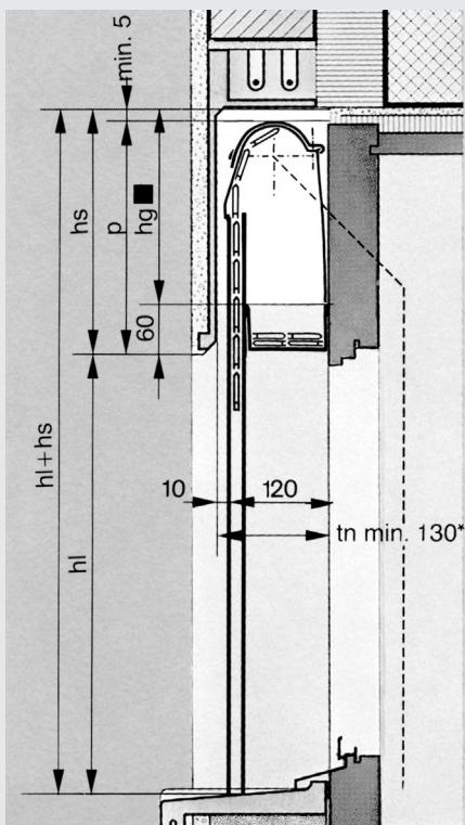
Die Höhe der Getriebeaussparung hg richtet sich nach der notwendigen Sturzhöhe hs. Bei Motorantrieb beträgt die Höhe hg mindestens 200 mm. In solchen Fällen muss deshalb bei Sturzhöhen hs von weniger als 260 mm der Normabstand von 60 mm zwischen unterkant Getriebeaussparung und unterkant Sturz entsprechend verringert werden.
