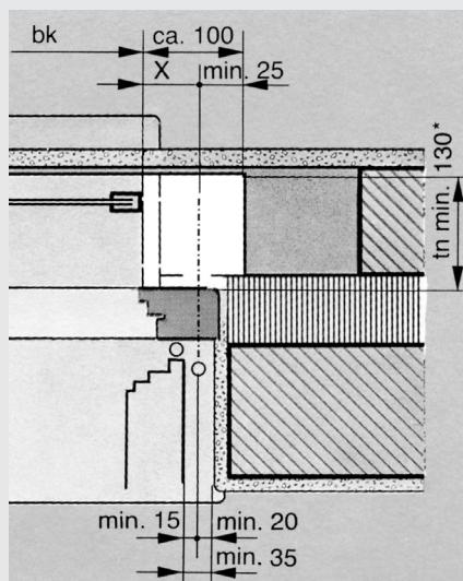
La hauteur de niche hg pour le moteur dépend de la hauteur de linteau hs nécessaire. Commande par moteur: la hauteur totale hg est de minimum 200 mm. Lorsque la hauteur de linteau hg est inf. à 260 mm, la distance normale de 60 mm entre l'arrête inférieure de niche et l'arrête inférieure de linteau doit être diminuée d'autant.
