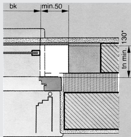
L'altezza della nicchia hg per l'arganello o il motore dipende dall'altezza necessaria della veletta hs. Comando a motore: l'altezza hg minima è di 200 mm. Nel caso di altezze della veletta hs inferiori a 260 mm, la distanza standard di 60 mm tra spigolo inferiore della nicchia e spigolo inferiore della veletta viene ridotta adeguatamente.
