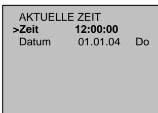
Fahren Sie mit dem Pfeil auf „**Zeit**“ und bestätigen Sie mit der -Taste. Verstellen Sie nun mit den Tasten und die Zeit. Mit den Tasten und fahren Sie nach links und rechts. Bestätigen Sie dann die eingestellte Zeit mit der -Taste.
