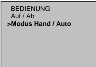
Gehen Sie ins Untermenü „BEDIENUNG“, fahren Sie mit dem Pfeil auf „**Modus Hand / Auto**“ und bestätigen Sie mit der
