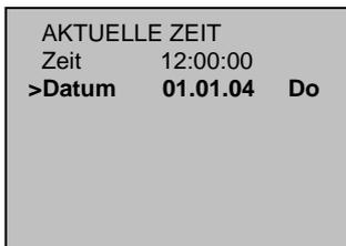
Fahren Sie mit dem Pfeil auf „**Datum**“ und bestätigen Sie mit der -Taste. Verstellen Sie nun mit den Tasten und das Datum. Mit den Tasten und fahren Sie nach links und rechts. Bestätigen Sie dann das eingestellte Datum mit der -Taste.
