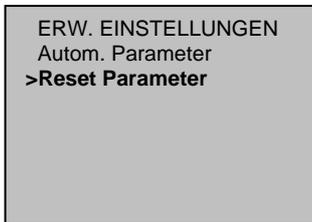
Fahren Sie mit dem Pfeil auf „**Reset Parameter**“ und bestätigen Sie mit der
