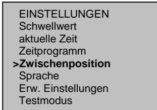
Gehen Sie ins Untermenü „EINSTELLUNGEN“, fahren Sie mit dem Pfeil auf „**Zwischenposition**“ und bestätigen Sie mit der -Taste.
