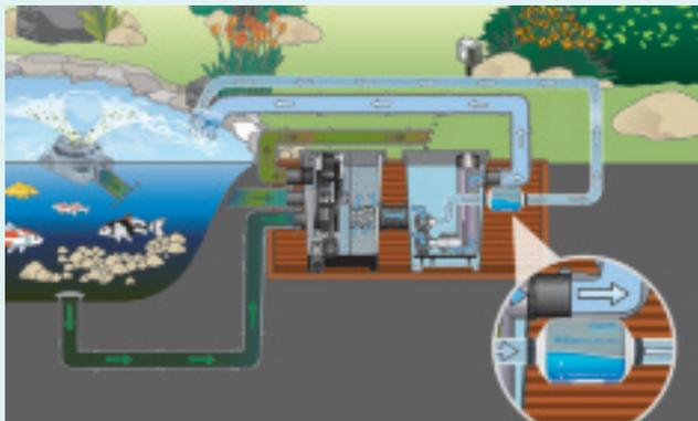
2. In Kombination mit einem Druckfilter. Bei Bedarf mit zweiter Pumpe zur Druckerhöhung.
