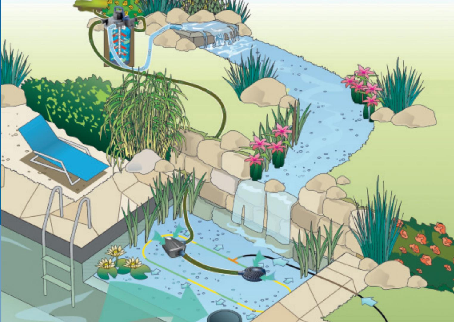
Schematische Darstellung: Filter- und Bachlaufpumpe AquaMax Eco Premium 12 V eingesetzt im Schwimmteich in Kombination mit einem OASE-Druckfilter FiltoClear
