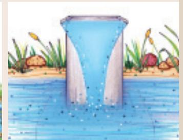
Verbinden Sie nun Pumpe und Schlauch. Dann öffnen Sie die Rückwand und befestigen den Schlauch. Dieser wird dann an der rückseitigen Öffnung hinausgeführt und die Pumpe im Wasser versenkt. Fertig!
