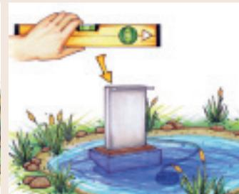
Für ein perfekt ausgerichtetes Wasserspiel achten Sie unbedingt auf den waagerechten Aufbau. Nehmen Sie eine Wasserwaage zur Hilfe.
