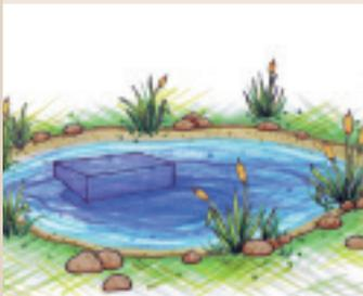
Als erstes schaffen Sie eine gerade und feste Fläche – eine solide Basis z.B. aus Beton, die als Sockel dient.
