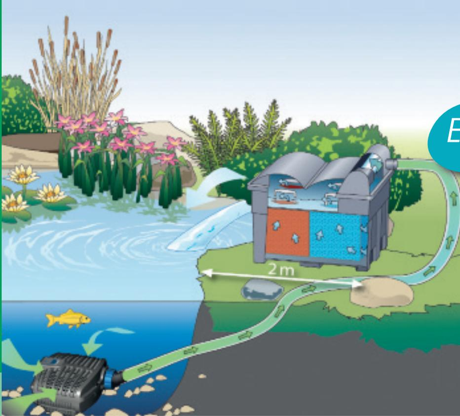
Schematische Darstellung: BioSmart Set Komponenten in Funktion
