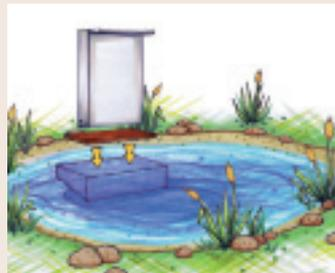
Der Waterfall 30 wird nun auf dieser geraden Platte montiert: Dazu mit rostfreien Edelstahlschrauben die zwei seitlichen Befestigungsglaschen fixieren.
