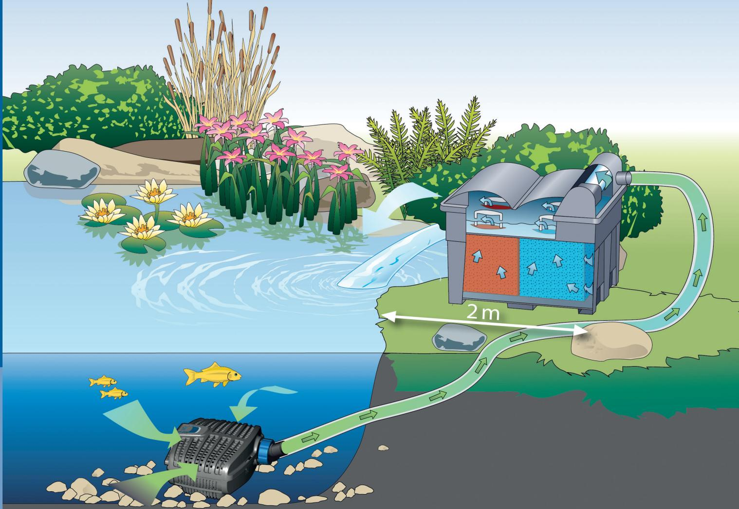
Schematische Darstellung: BioSmart UVC 16000 in Kombination mit Filter- und Bachlaufpumpe AquaMax Eco Classic
