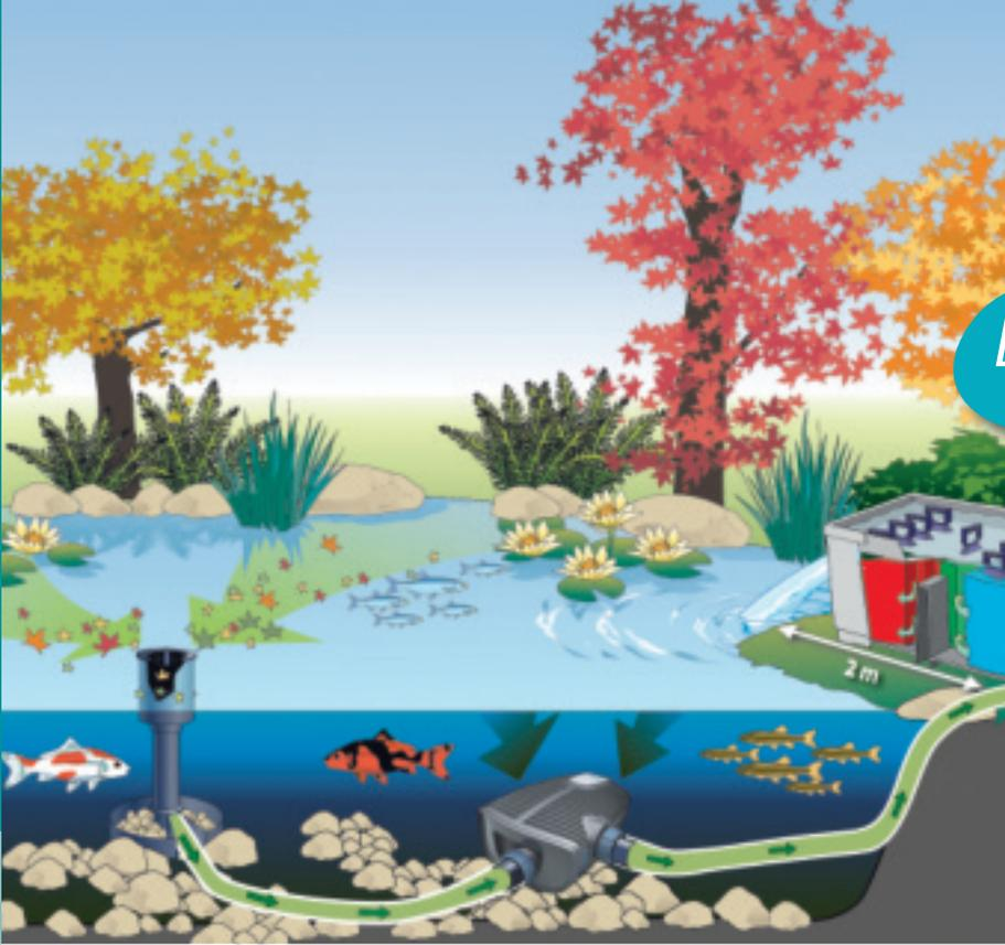
Schematische Darstellung: AquaSkim im Einsatz mit einer Filter- und Bachlaufpumpe AquaMax Eco Premium
